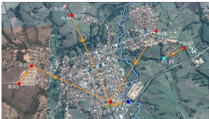
Figura 3: Ilustração do modelo hidráulico da produção e distribuição de água no município.
